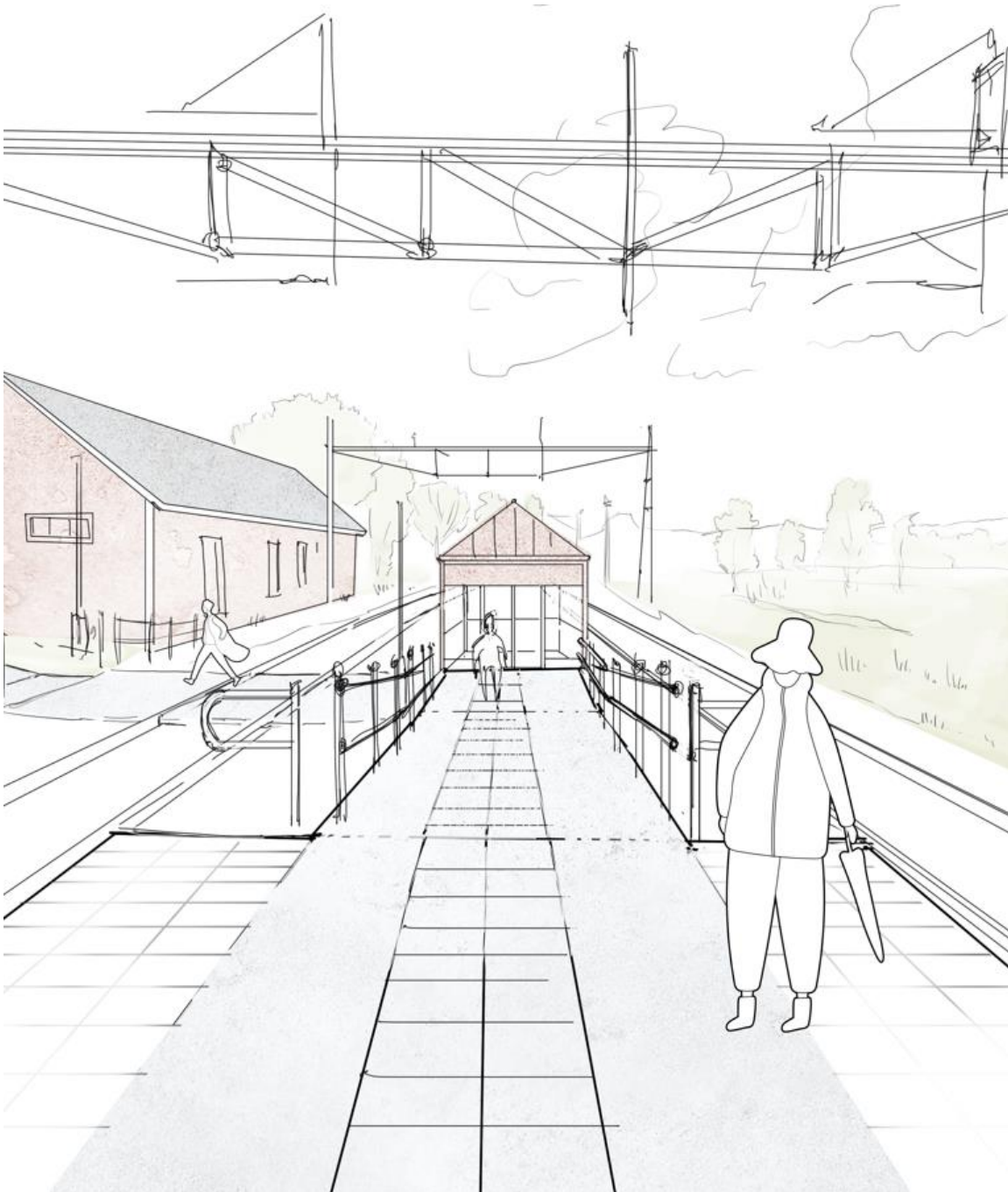
Figur 91: Exempel på utformning av uppvärmt väderskydd i den östra änden av plattformen. Illustration: Sweco 2025
