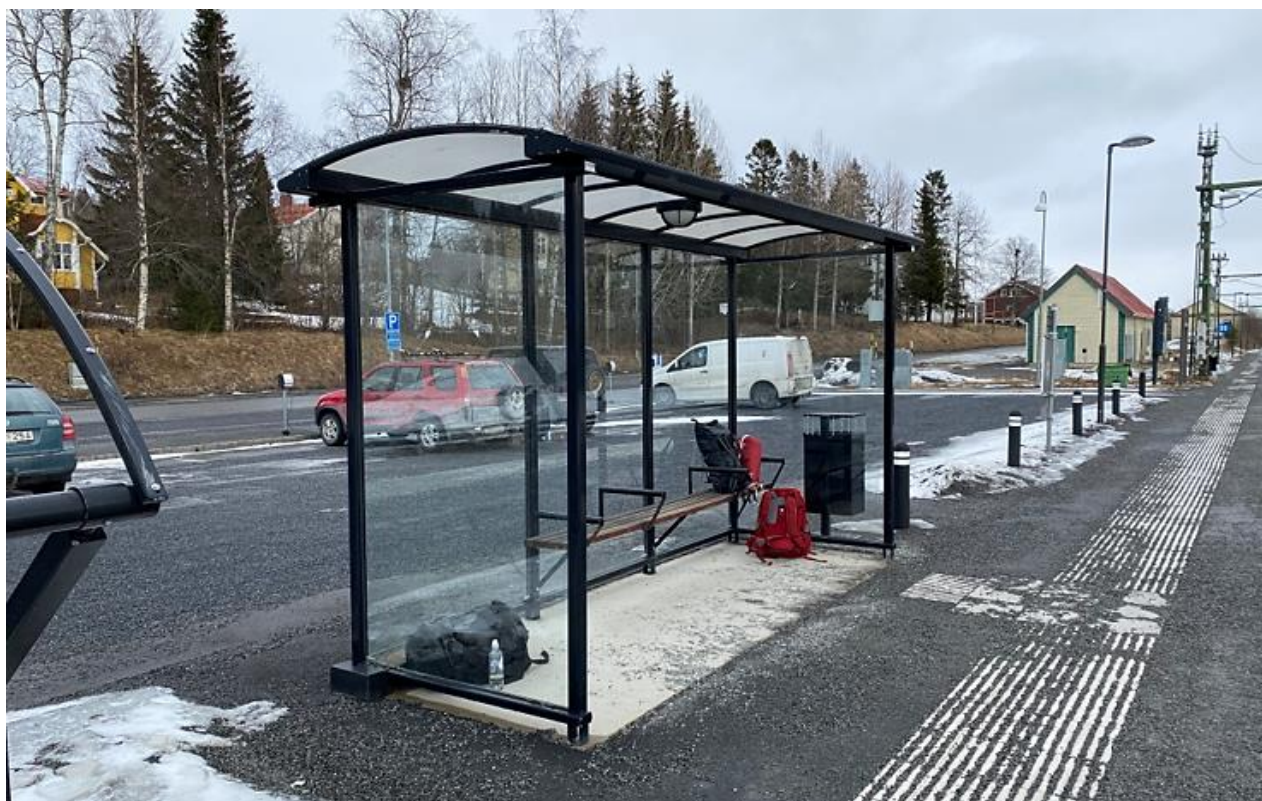
Figur 42: Tillgänglighetsanpassat väderskydd med sittplatser med rygg- och armstöd. Bild: Sweco 2025
