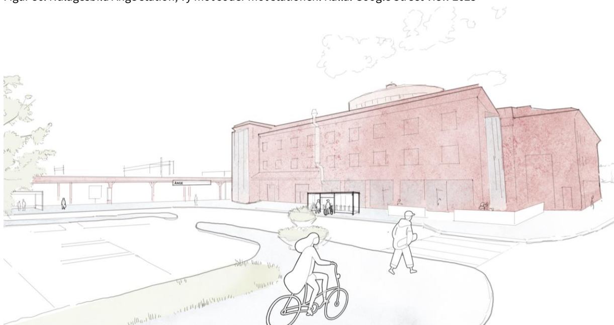
Figur 87: Exempel på utformning av angöring och ankomstzon för gående och cyklister. Illustration: Sweco 2025
